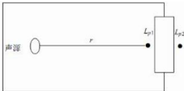
图 4-4 室内声源等效为室外声源图例
